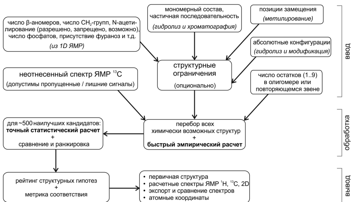
Рис. 39. Входные данные (секция «ввод»), выходные данные (секция «вывод») и последовательность шагов (секция «обработка») при генерировании структурных гипотез с помощью алгоритма GRASS.
